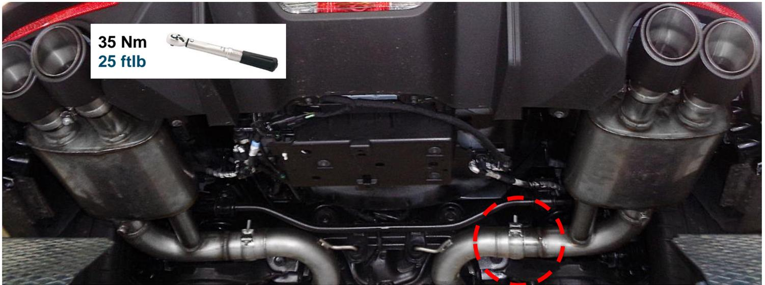
Die REMUS Endrohre am REMUS Sportschalldämpfer montieren und ausrichten.
