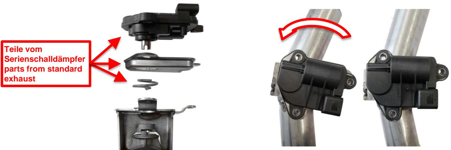
Den REMUS Vorschalldämpfer, mit Hilfe der mitgelieferten Adapter, am Serienrohr montieren. Das linke und rechte Verbindungsrohr am Vorschalldämpfer montieren und die Halter an den Befestigungspunkten der Karosserie einhängen.
